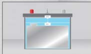
diseño con electrodos dispuestos más abajo y, por tanto, con mayor cabida para el ácido
